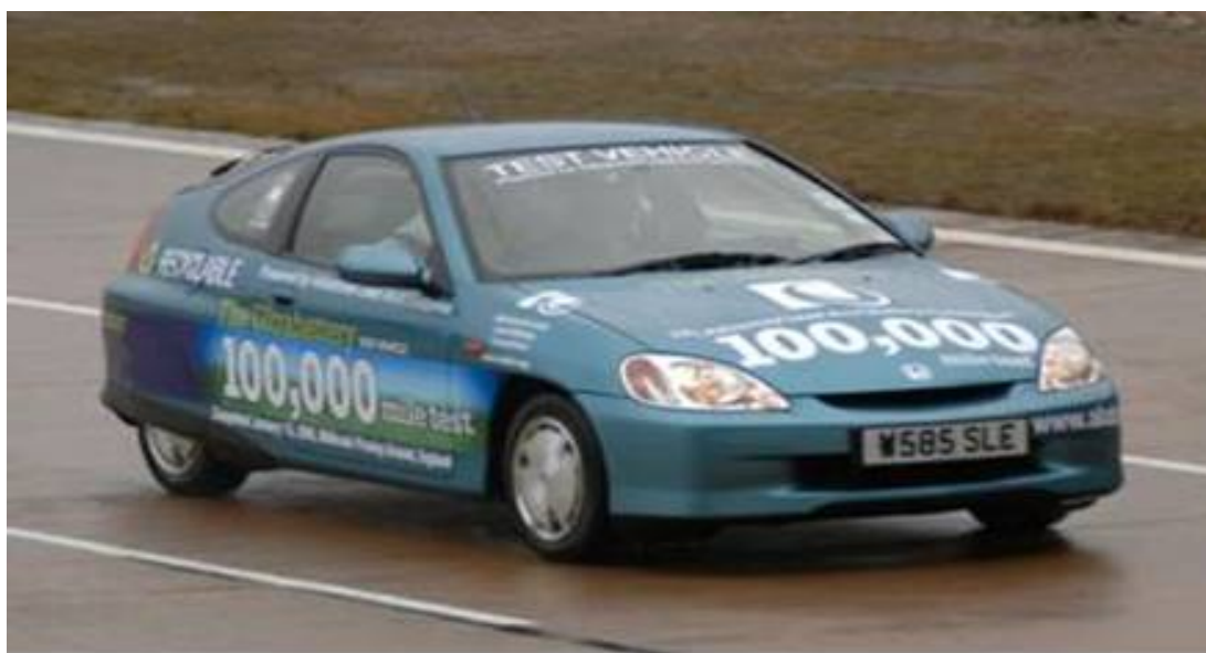
図 6.19 フィールド実車試験にて 100,000 マイル（約 160,000 km）の走行を達成したプロトタイプ・キャパシタハイブリッド型鉛蓄電池搭載ホンダ・インサイト HEV
